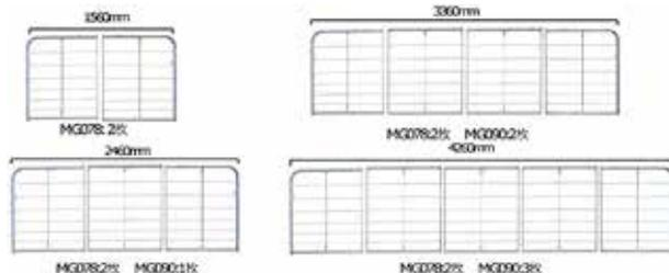
端部のパネル(MG078)の間に中間のパネル(MG090)を追加すると目的に合わせて様々な長さのパネルを作ることができます。また数年後など別の長さに変更したいときも変更可能。
