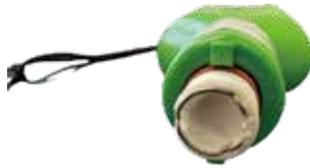
先端のチップを押し付けると加熱します。
