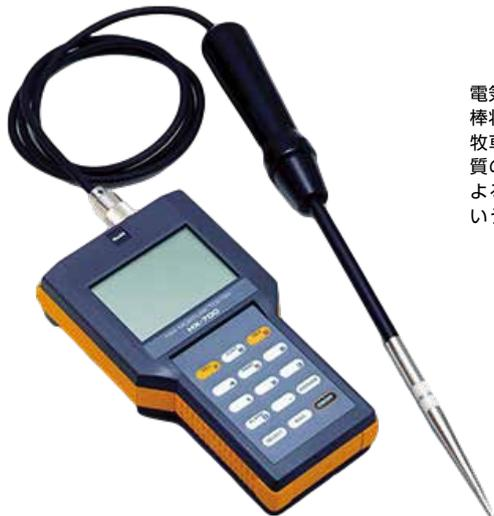
電気抵抗を応用した牧草水分計で、乾燥中あるいは貯蔵中の牧草に、棒状のセンサを挿入するだけで水分(%)を表示します。牧草貯蔵時の乾燥不足は発酵腐敗の原因となりますし、過乾燥は品質の低下を招きます。また、牧草飼料の取り引きにおいては、水分による質量の増減は重要な問題です。このような問題を解決したいというニーズに、開発されたのがHX-700です。
